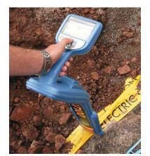
Elle contribue ainsi à obtenir une détection précise des canalisations ou des câbles cibles même en environnements électriques perturbés, par exemple à proximité de lignes aériennes haute tension.
