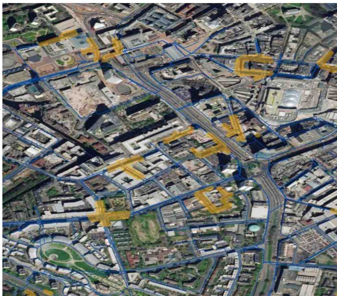
Dit is een satellietbeeld van een niet nader genoemde stad. De blauwe lijn is het waternetwerk, de geel geaccentueerde delen zijn de lekken. FOTO WATER-LINK
