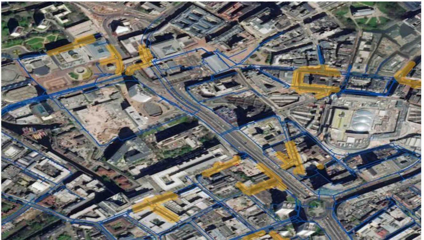
Satellietbeeld van een niet nader genoemde stad: de blauwe lijn is het waternetwerk, de geel geaccentueerde delen zijn de lekken. © water-link
